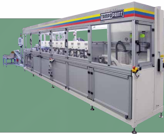
Referans-Oyuncak sanayi: Tam otomatik 12 renk tampon baskı sistemi. Baskı hızı: 24 000 adet baskı/saat
